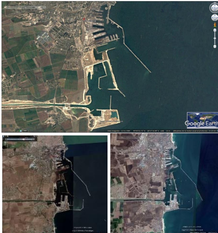
Figura II.6.1.6. Etapele de extindere a digului de Nord în perioada 1984 – 2012 - 2015
