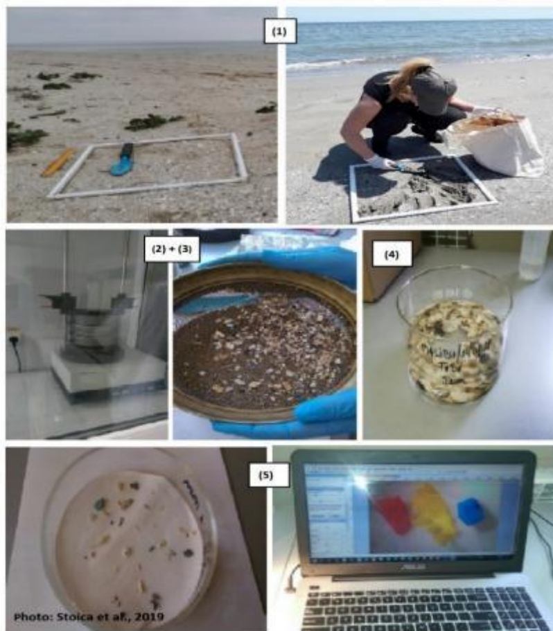
Figura III.10.4. Principalele etape în monitorizarea microplasticelor din nisipul plajelor marine, conform protocolului INCDM: (1) colectarea probelor de nisip de pe locul de analizat; (2) sitarea nisipului; (3) colectarea particulelor pe site cu dimensiuni între 1 și 5 mm; (4) separarea microplasticelor în soluție salină (5) clasificarea și înregistrarea microplasticelor (Foto: Stoica și colab., 2019)
