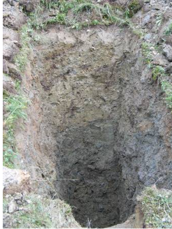
Valea Corna - Put geotehnic in depozite coluviale
