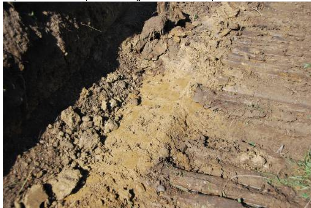
Valea Corna – depozite coluviale dezvelite de construcția unui drum. Se poate observa conținutul ridicat de argila.
