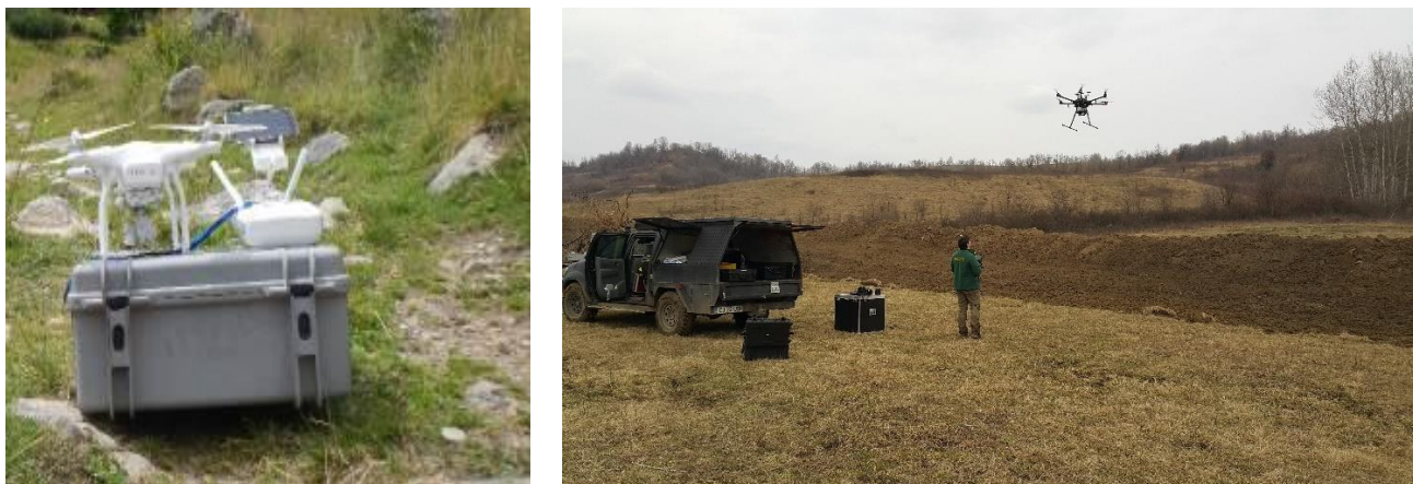
Fig. 115 Drona DJI Phantom III-Advanced pregătită de zbor (stânga); Dronă DJI Matrice 600 PRO cu unitate LiDAR
