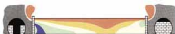
Condiții optime, cu temperatură și grad de umiditate relativ stabile. Proporția închiderii depinde de lungimea tunelului.
