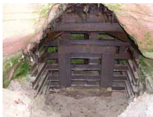
Grilaj cu secțiune mare, Lambertsberg, Germania.
