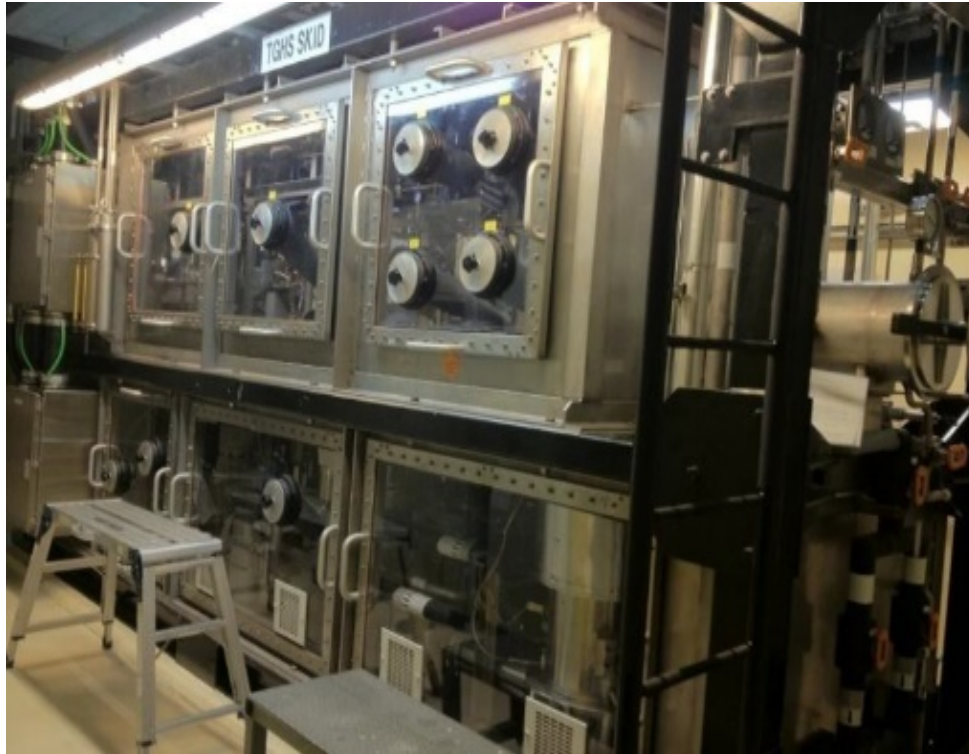
Fig. III.14 Sistemul de manipulare și stocare a tritiului gaz de la WTRF- Coreea
