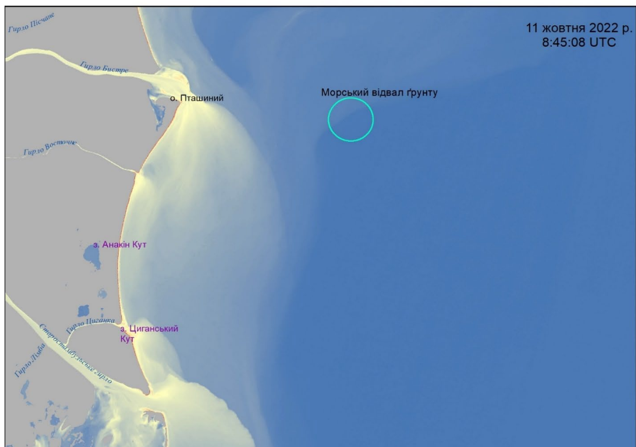
Рис. 6.9. Концентрації завислих речовин у прибережній частині акваторії Чорного моря в районі гирл Бистре та Старостамбульське (вересень-жовтень 2022 р.)
