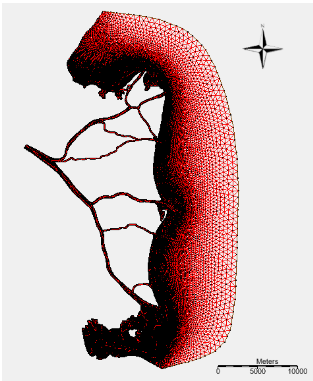
Рисунок 9.14. Розрахункова сітка області двовимірного моделювання. Сучасний стан. Загальний вигляд. Проекція UTM35, EPSG: 32635.
