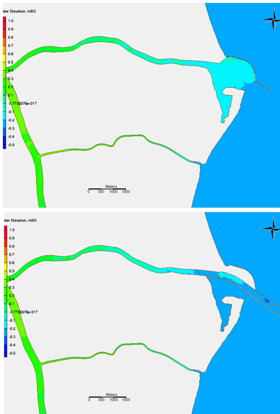
Рисунок 9.20 . Рівні води на області двовимірного моделювання для сталої витрати 6000 м 3 /с в Кілійському рукаві в районі м. Вилкове. Балтійська система висот. Район рукава Бистрого і огорожувальних дамб у гирлі рукава. Сучасний стан і 3-й етап будівництва - дамби повного розвитку із підхідним каналом. Проекція UTM35, EPSG: 32635.
