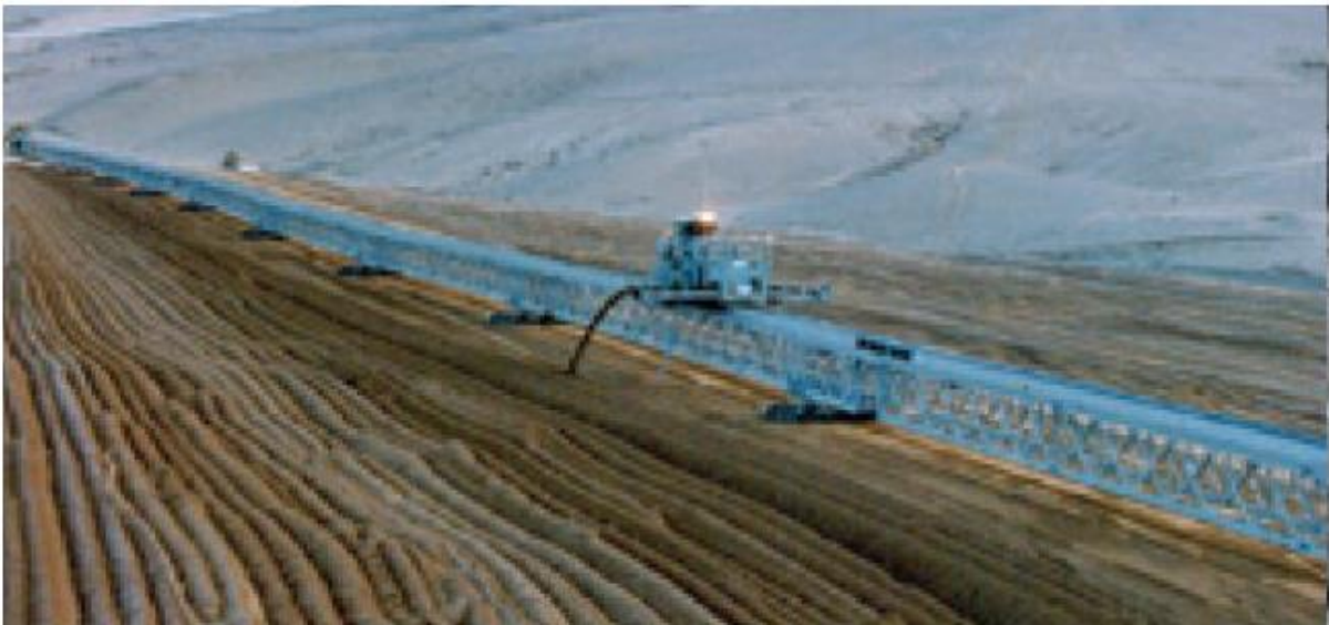
Figura 3.3.4-11: Banda transportorului de distribuție cu cărucior de descărcare
