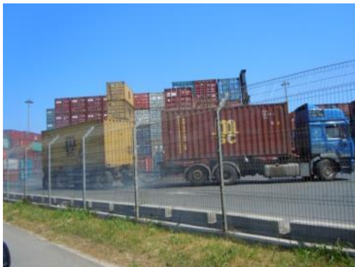
Figura 8.2 Camion de containere în terminalul DP World care transportă două containere 20' pentru compania mediteraneană de transport
