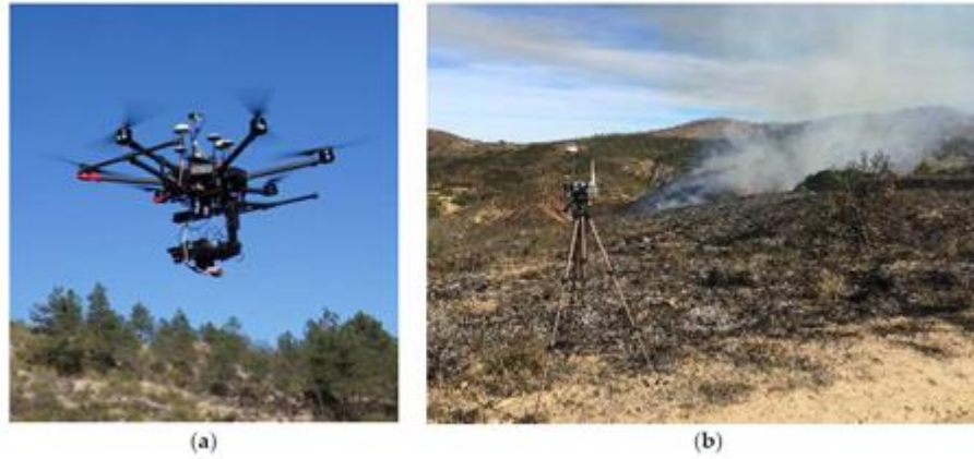
Figura 2.27: Vehicul aerian fără pilot (UAV): (a) DJI Matrice 600 Pro cu o cameră multispectrală Parrot Sequoia 153 la bord și antenă de navigație D-RTK; (b) Stația la sol a dispozitivului de poziționare și navigare GNSS (D-RTK Global Navigation Satellite System) (Carvajal-Ramírez și colab., 2019).
