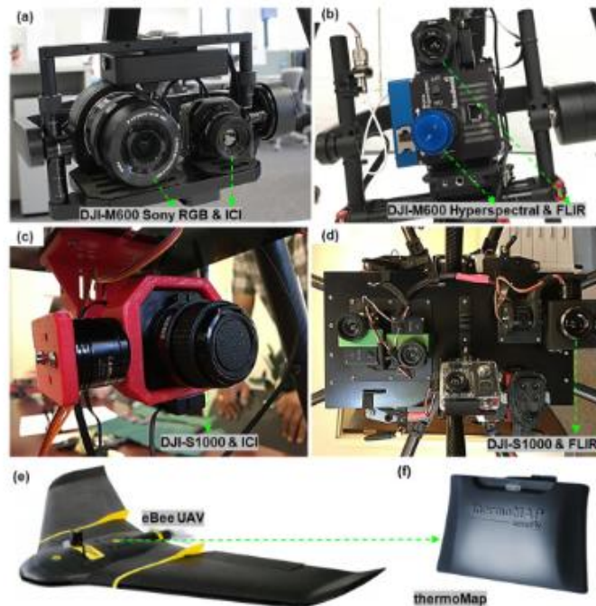
Figura 2.24. Sistemele UAV și camerele termale; (a) - Camere Sony RGB și ICI integrate pe un hexa-copter DJI M600 Pro; (b) - Camera hiperspectrală și FLIR integrate pe un hexa-copter DJI M600 Pro; (c) - Octo-copter DJI S1000 și camera FLIR; (d) - UAV eBee și camera thermoMap (Sagan și colab., 2019)
