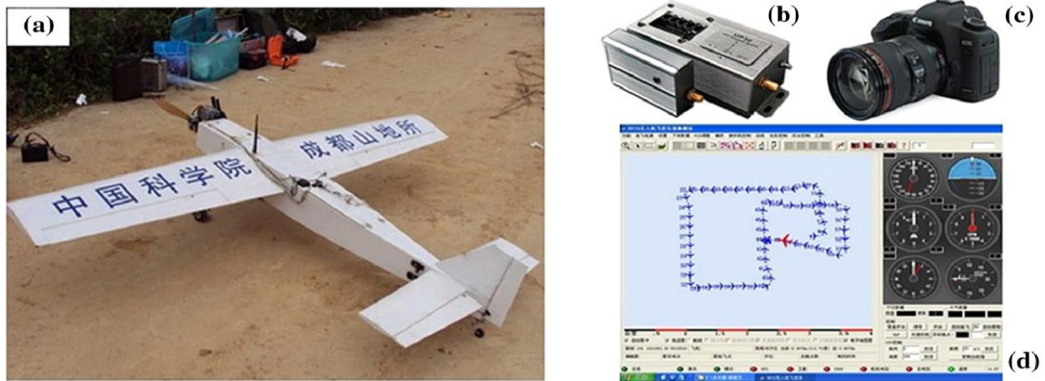
Figura 2.12: Sistemul de teledetecție UAV utilizat pentru observarea condițiilor de gheață a râului Galben: (a) platforma UAV cu aripă fixă; (b) sistem de control al zborului; (c) aparat de fotografiat digital; și (d) sistemul de control al stației de la sol (Lin și colab., 2012)
