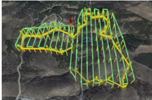
Figura 2.29: Planificare atât pentru zboruri fotogrametrice înainte, cât și după incendiu. Toate punctele de referință au aceeași altitudine (56,2 m peste nivelul solului) (Carvajal-Ramírez și colab., 2019).
