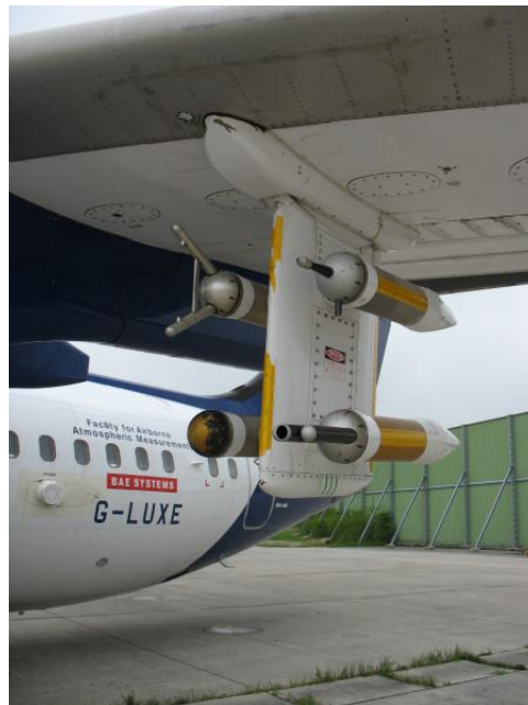
Figura 1.20: Ilustrarea unor modalități consacrate de amplasare a instrumentelor pe aripile aeronavelor ( Centre for Atmospheric Sciences, Manchester )
