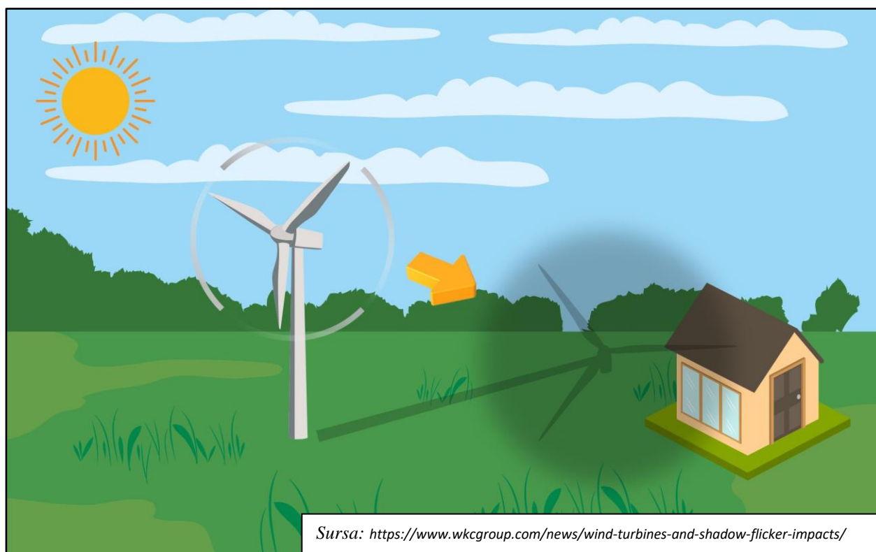
Fig. 15 Reprezentare schematică a impactului umbririi intermitente
